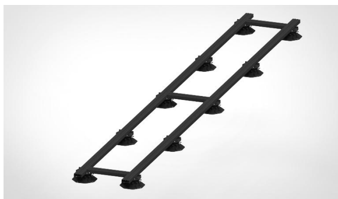
Bild 11. Im ersten Feld sollten 3 Querstücke eingebaut werden. Alle Querstücke sind mit den Terrassenlagern zu verschrauben.
