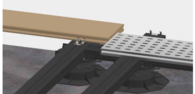
Bild 23. Anschließend wird die erste WPC-Diele und das Drainageprofil auf die Rand-Clips aufgeschoben.
