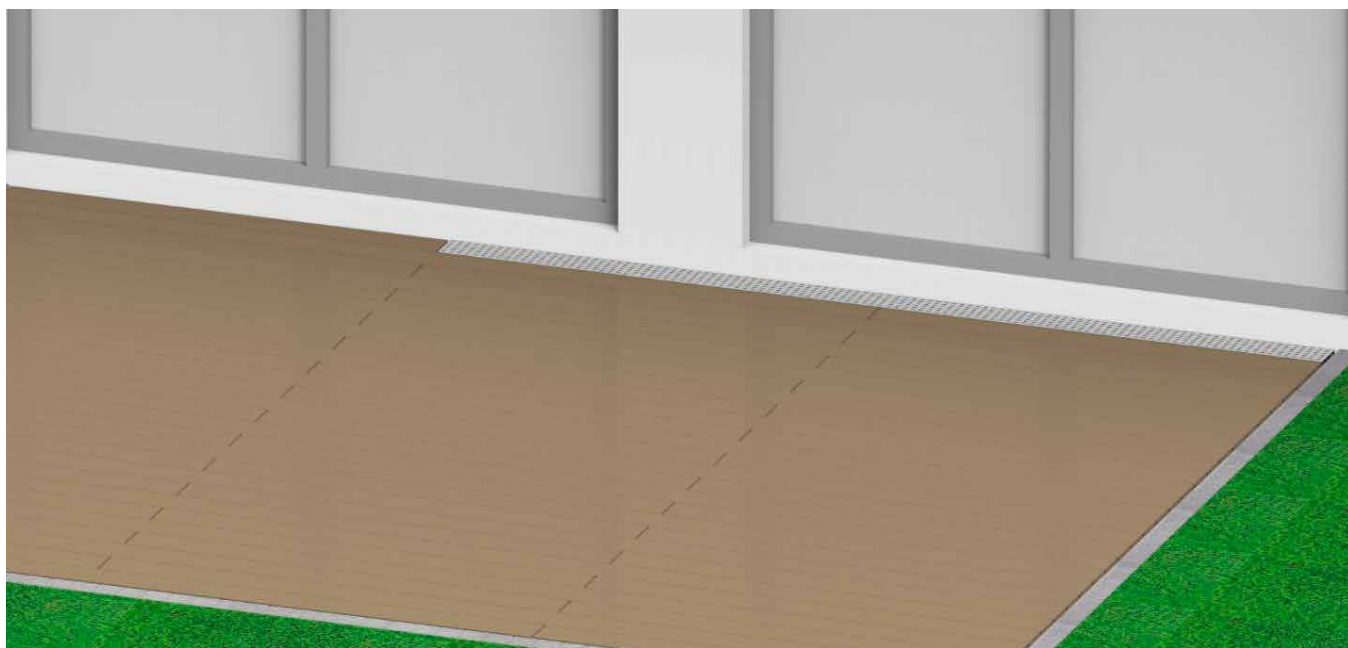
Bild 21. Entwässerungsroste bzw. Drainageprofile müssen bei geringeren Austrittshöhen \leq 150 mm grundsätzlich eingebaut werden.
