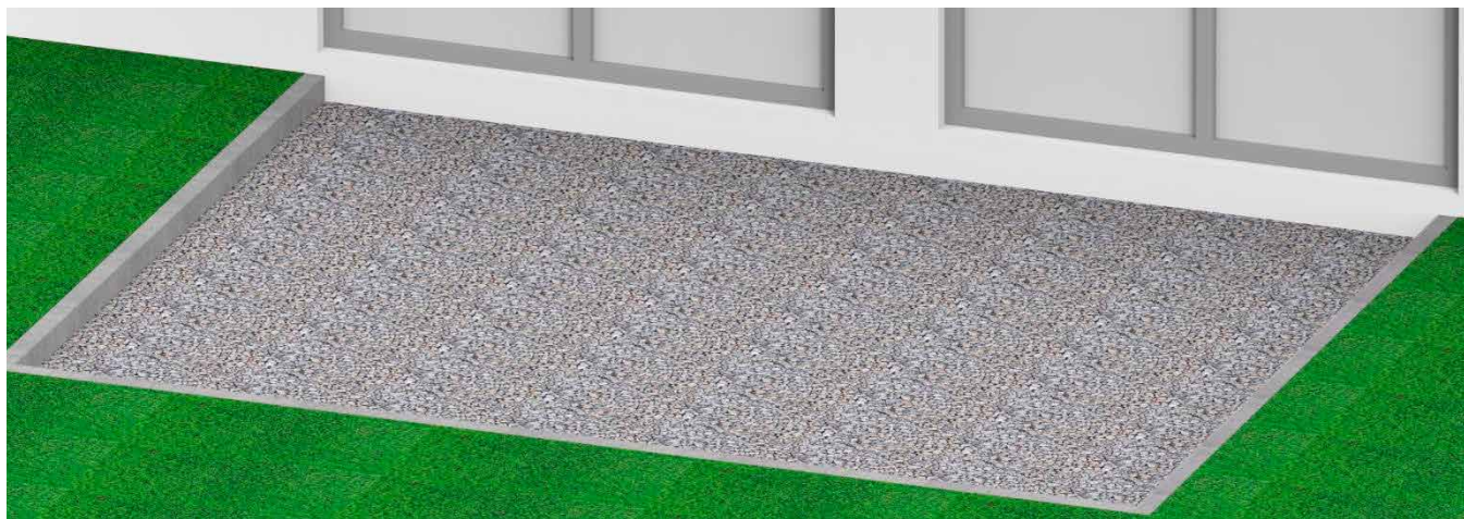
Bild 1. Eine Steinumrandung verhindert z. B. das Einwachsen des Rasens zwischen die WPC-Terrassendielen und stellt immer einen ausreichenden Fugenabstand und eine gute Belüftung unter der Terrasse sicher.
