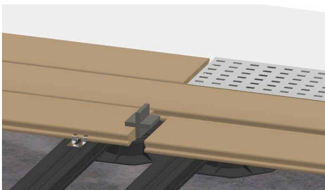
Bild 26. Beachten Sie die notwendigen Fugenabstände an den Längsstößen der WPC-Dielen. Je nach Verarbeitungstemperatur muss der Fugenabstand gewählt werden. Mit Abstandshaltern kann ein gleichmäßiger Fugenabstand an den Stoßfugen sichergestellt werden.
