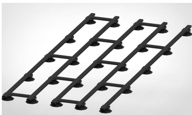
Bild 12. Die Querstücke sollten versetzt in den nächsten Feldern montiert werden, so dass eine ausgesteifte Konstruktion entsteht. Mindestens 2 Querstücke je Feld sind erforderlich.
