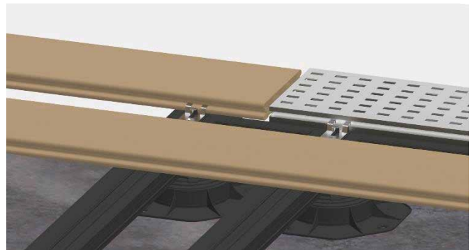
Bild 25. Wenn die erste Reihe befestigt ist, werden die nächsten WPC-Dielen auf die Distanz-Clips geschoben und ausgerichtet.
