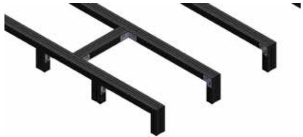
**Hinweis:** Ohne Rahmen kann die Terrasse nicht mit Abschluss- oder Universalprofilen gestaltet werden, da das Ende der Aluminium-Unterkonstruktionen hohl ist. Um Universalprofile anzubringen, müssen vertikale Rückläufe vorgesehen werden, siehe Abschnitt „INSTALLATION VON ABSCHLUSS- ODER UNIVERSALPROFILEN ALS SETZSTUFE“, Abbildung 36 auf Seite 15.
