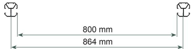
**Tipp:** Um eventuelle Fehler beim Achsabstand zu vermeiden, wird empfohlen, das Gitter als Schablone zu nutzen, indem man es vor dem Einbetonieren bzw. der Montage der Befestigungsplatten zu zwei Dritteln der Gesamthöhe einsetzt. Zur Anbringung des Gitters an den Pfosten lesen Sie bitte Schritt 2.
